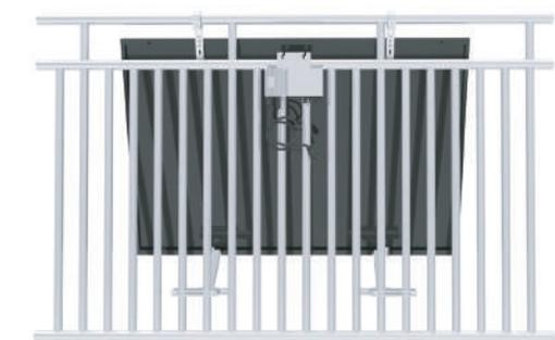
Befestigung des Wechselrichters am Geländer mit Edelstahlbindern
